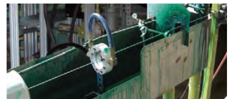
A モデル2431 1インチ(25mm)サイズの標準エアワイパーはタンクに漬けたワイパーの余分なコーティングをブローオフします。
