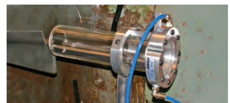
標準エアワイパーは部品から冷却水をブローオフし、センターレスグラインダーに戻します。
