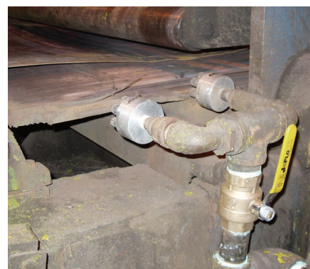
スーパーエアノズルクラスターは6フィート (1829mm) 連続鉄片の両面にわたって破片ゴミをブローオフします。
